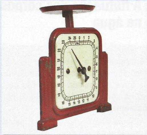
**Balança:** um dinamômetro que mede a deformação de suas molas e permite calcular o "peso" dos materiais.
